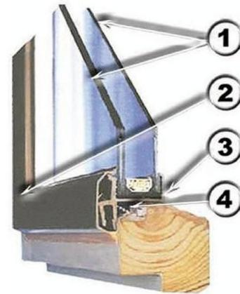
křídla jakéhokoli dřevěného okna na kvalitní termoizolační sklo se zaručenými parametry (1) pomocí štíhlých plastových profilů (2). Profilové montážní lišty z PVC tvoří nerozebiratelný komplet včetně vnějšího krytu. Umožňují rychlou a jednoduchou montáž izotermického dvojskla bez zásahu do stávajícího okna (3) a bez pracného odstranění zbytků starého zasklení (4). Dodávají se v barevném provedení: bílá, světle hnědá, tmavě hnědá, slonová kost, palisandr.
