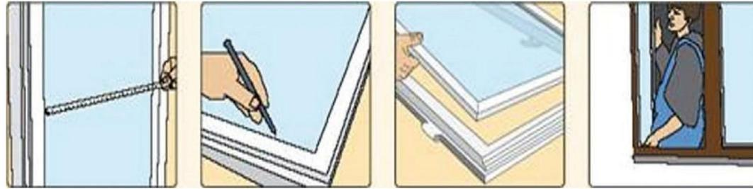
Dnes je již mnoho vyměněných oken, kde je nevhodné izolační dvojsklo. Před 5-10 lety se montovala dvojskla s koeficientem prospunu tepla  $U=2,8 \text{ W/m}^2\text{K}$ , tzn. dnes má takové sklo nedostatečnou tepelnou izolaci, která již nevyhovuje normám a projevuje se nepřijemným prospupujícím chladem a výskytem nadměrného rosení.
